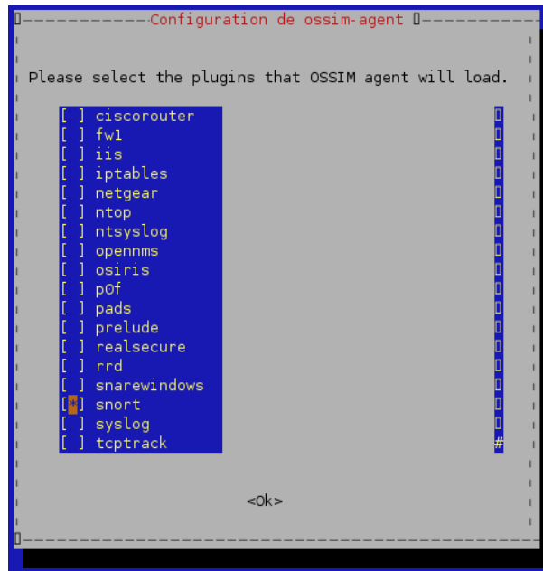
FIG. B.1 – Interface de configuration (dpkg) des plugins à utiliser sur un agent Ossim
